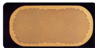
◀ リニアモーターカーや医療用 MRI に使われている超電導線断面図
